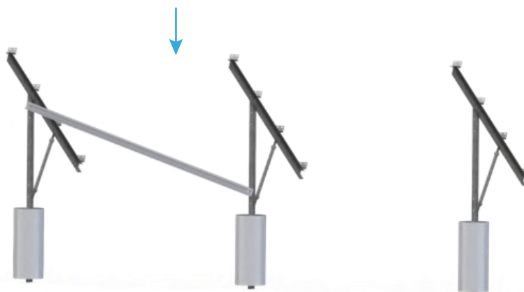
Figura 14 - Reforço de contraventamento
