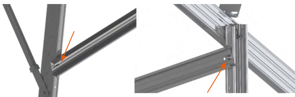
Figura 15 - Furos superiores nas laterais dos pilares para a fixação do contraventamento
