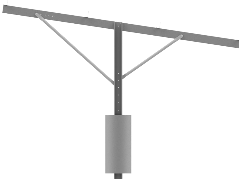
Figura 11 - Instalação das mãos francesas.
